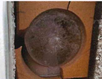
Frostschaden durch Wasserrückstau bis zur Revision, verursacht durch zugefrorenen Siphon
